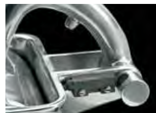
Microinterruttore su leva Micro-switch on lever
